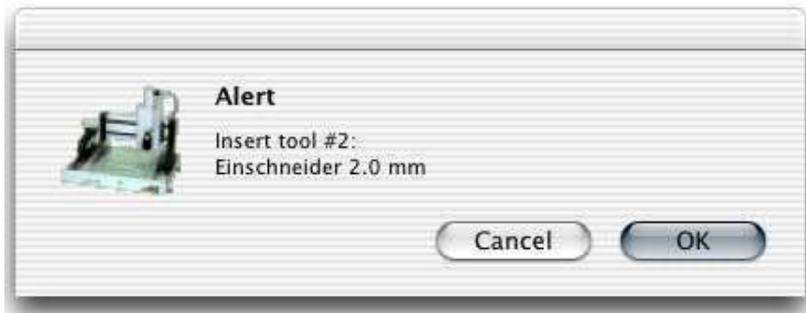
Nach Bestätigung mit OK beginnt die Anlage sofort mit der Bearbeitung des Werkstücks. Dabei werden die Lagen in der umgekehrten Reihenfolge bearbeitet, in der sie im Lagen-Panel aufgelistet sind (von unten nach oben), d. h. in unserem Fall wird zuerst graviert.
