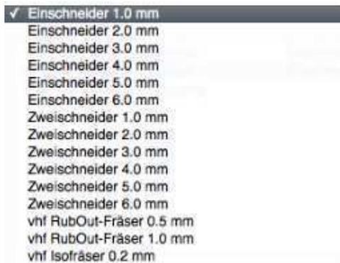
Über das Pop-Up-Menü daneben können Sie schliesslich ein Werkzeug auswählen, mit dem der jeweilige Arbeitsschritt später auf Ihrer Gravieranlage bearbeitet werden soll. Achten Sie hierbei unbedingt auf den richtigen Werkzeugdurchmesser, da dieser für alle Berechnungen herangezogen wird. Es werden dabei alle Werkzeuge angezeigt, die im aktuell gewählten Magazin enthalten sind.
