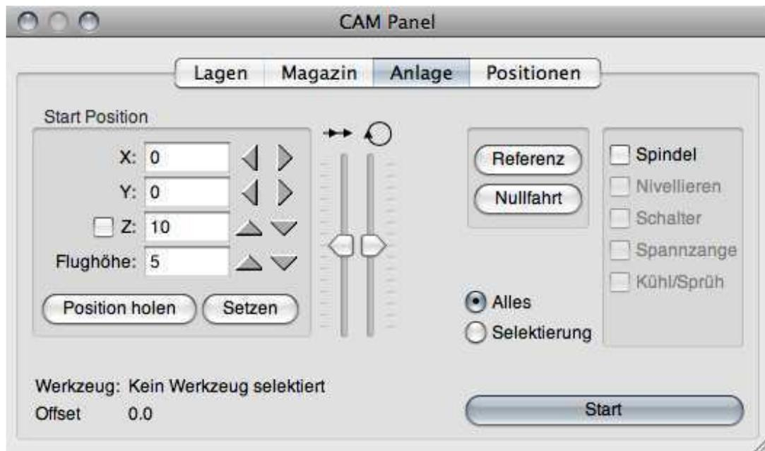
Oben in der Leiste kann nach Art eines Karteikastens die Funktion des CAM-Panels gewählt werden. Je nach Ihrer Wahl ändern sich das Aussehen und die Einstellmöglichkeiten des Panels.
