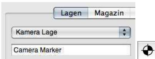
Auf der Kamera-Lage werden die Markierungspunkte an den Soll-Positionen (also passend zur Grafik) plaziert. Diese Markierungspunkte müssen in irgendeiner Weise (Kreuze, Punkte, ...) auch auf den Werkstücken vorhanden sein, in der Regel aufgedruckt. Es werden mindestens drei Markierungspunkte benötigt.
