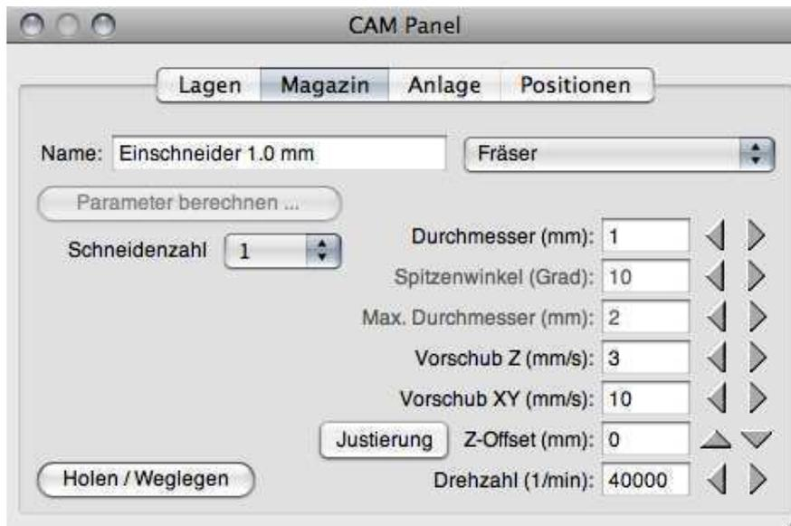
Hier finden Sie unter anderem einen Eintrag namens Z-Offset. Über diesen geben Sie die Höhendifferenz zu dem Werkzeug mit der grössten Länge ein (mit diesem muss dann auch der Wert Z Kontakt festgelegt werden). Wenn also das längste Werkzeug beispielsweise vom Anschlagring bis zur Spitze 38 mm misst und das aktuelle nur 30, dann müssen Sie bei Z-Offset eine 8 eintragen. Der Knopf Justierung dient dazu, den Offset direkt durch Ausprobieren zu ermitteln.
