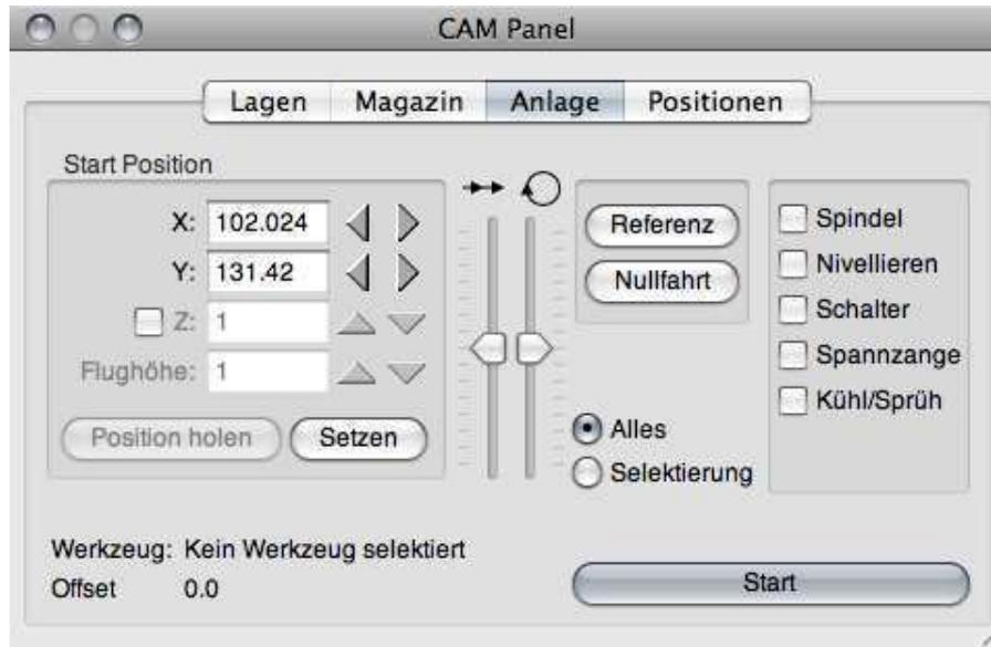
Die Ausgabe wird wie gewohnt im Control-Panel mit dem Start-Knopf gestartet. Die Start-Position wurde nach der Zentrier-Fahrt des Referenzpunktes auf dessen Position gesetzt (dem Fadenkreuz im Grafik-Fenster kommt bei der Kameravermessung keine Bedeutung zu!).
