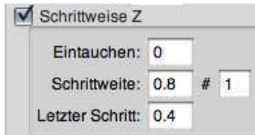
Canon unterstützt die stufenweise Bearbeitung von Werkstücken. Hier kann für ein Werkzeug angegeben werden, wie tief mit dem ersten Durchgang eingetaucht wird, in welchen Stufen die weiteren Durchgänge maximal bearbeitet werden dürfen und wieviel für den letzten Durchgang verbleiben soll. Es wird dabei maximal bis zur Eintauchtiefe der Lage eingetaucht. Der Schalter links oben dient zum Ein- und Ausschalten der stufenweisen Bearbeitung.
