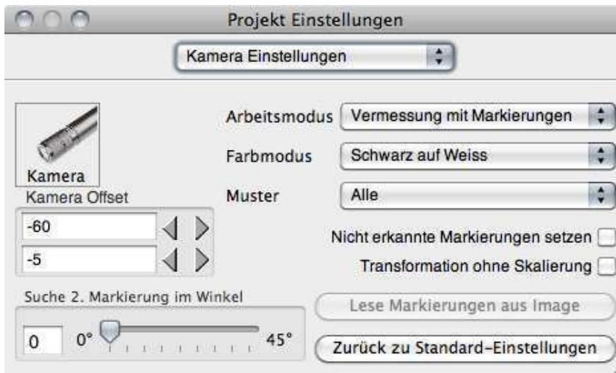
Die Kamera-Einstellungen erlauben es die Verwendung der Kamera zu konfigurieren, sowie verschiedene Parameter der Kamera anzupassen.
