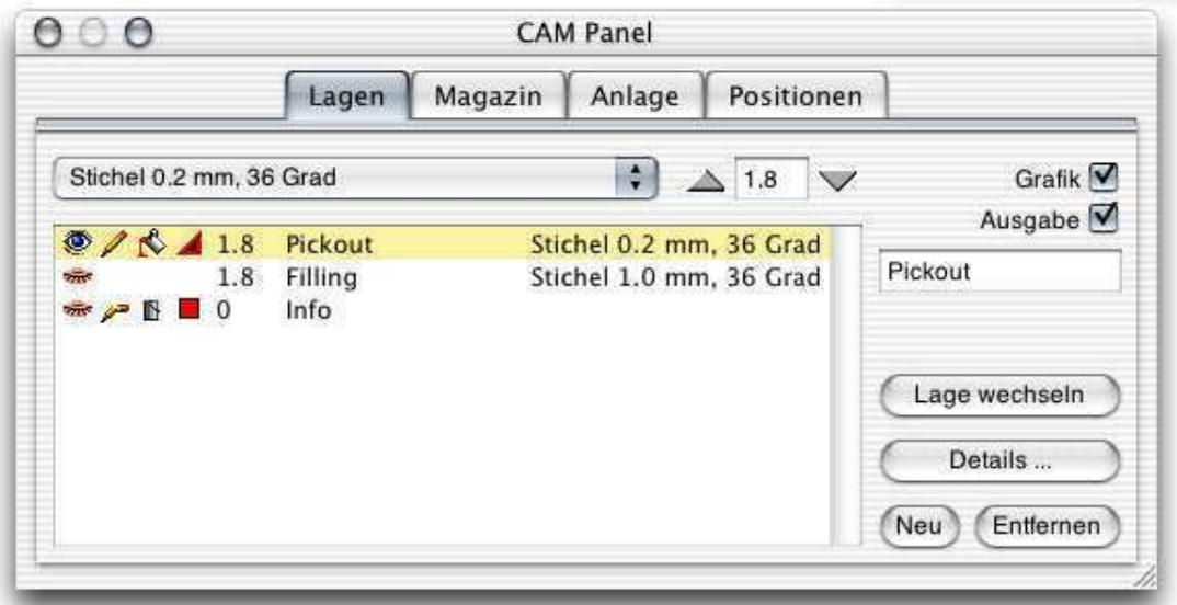
Das Ausspitzen stellt zwei Lagen zur Verfügung. Die erste Lage für das Ausspitzen und die zweite Lage für Ausräumungen.
