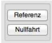
Hiermit kann eine Referenzfahrt oder eine Nullfahrt durchgeführt werden. Eine Referenzfahrt justiert die Anlage und kehrt an die Startposition zurück. Eine Nullfahrt fährt die Anlage auf Null und verbleibt dort.
