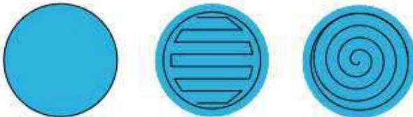
In der rechten Abbildung wird das Element gefüllt, es werden also die Fahrwege für einen bestimmten Werkzeugdurchmesser berechnet, mit dem der Kreis später graviert werden kann. Links wird der Kreis ohne Füllung ausgegeben.
