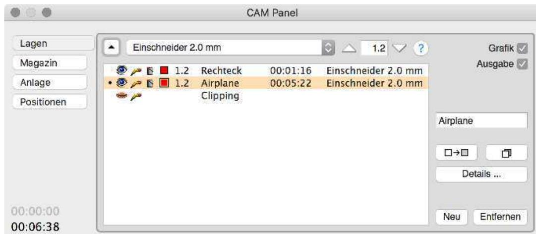
Das Lagen-Panel dient zur Verwaltung der verschiedenen Lagen. Die Lagen werden bei Cenon zum Trennen der einzelnen Bearbeitungsschritte (z. B. Gravieren und Fräsen) verwendet.
