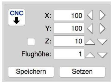
Sie sollten also für den Anfang die Startposition - also die linke untere Ecke des Werkstücks für X, Y und Z nur über die Pfeilfelder einstellen. Verfahren Sie X und Y zur linken/unteren Ecke Ihres Werkstücks. Senken Sie dann Z bis hinunter auf die Werkstück-Oberfläche, so dass die Oberfläche fast berührt wird. Wenn Sie gleichzeitig mit dem Anklicken der Pfeile die Strg-Taste drücken, wird die Anlage in 1 mm-Schritten positioniert.
