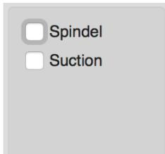
Hier können bis zu zehn Funktionen manuell geschaltet werden, sofern Ihr CNC-Controller über entsprechende Schaltausgänge verfügt. Die Belegung der Schalter wird in der Gerätekonfiguration (siehe Kapitel 4.2) definiert.
