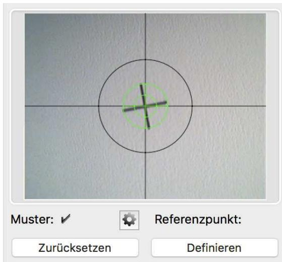
Verbindendes Element zwischen Grafik und Werkstück sind Referenzpunkte oder -Kreuze. Diese werden in Cenon als Markierungen auf einer separaten Lage plaziert. Die Bedienung ist anschliessend kinderleicht über nur zwei Knöpfe und drei Schritte:
